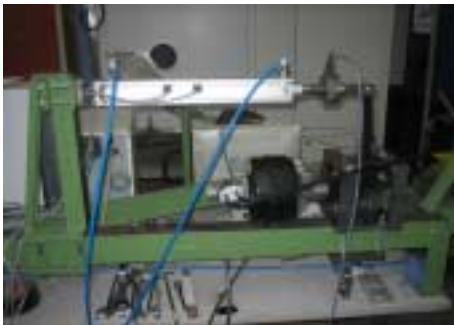
Prüfaufbau mit Pneumatik- und Hauptbremszylinder
