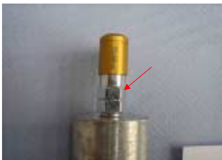
Prüfmuster Stahl nach Abwischen der Salzreste.
