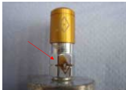
Korrosionsansatz der Stahlausführung
