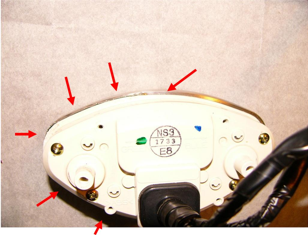
Nachdem mindestens 2/3 des Metallrings aufgebogen sind, kann der Tacho aus dem Metallring gezogen werden.
