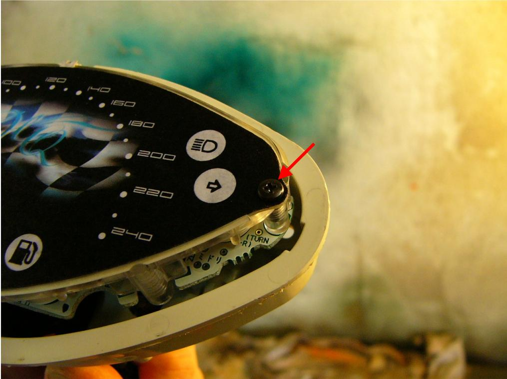
Die Schrauben an jedem Ende der Tachoscheibe lösen (zwei Schrauben).
