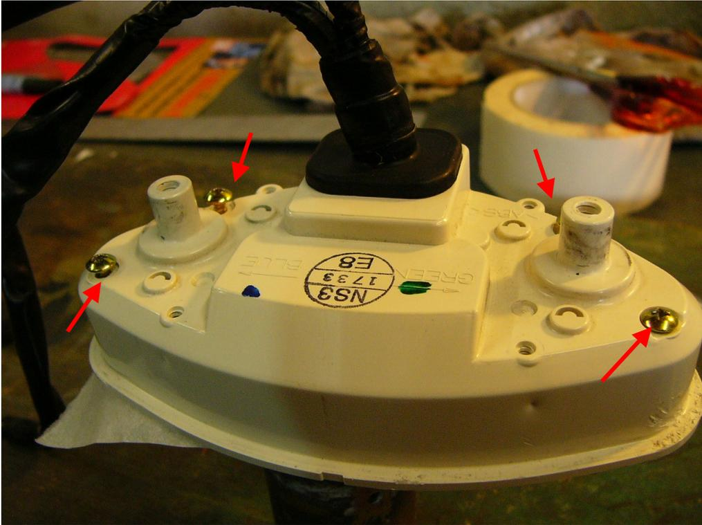
Die vier Schrauben lösen, damit der Unterbau (Innenleben) freigelegt werden kann.
